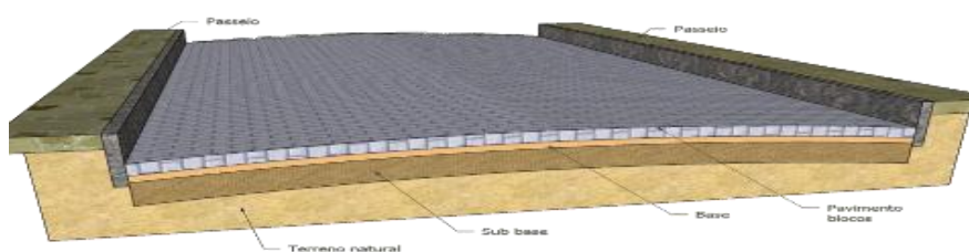
Figura 75 - Desenho esquemático do perfil transversal da pavimentação com blocos de concreto
